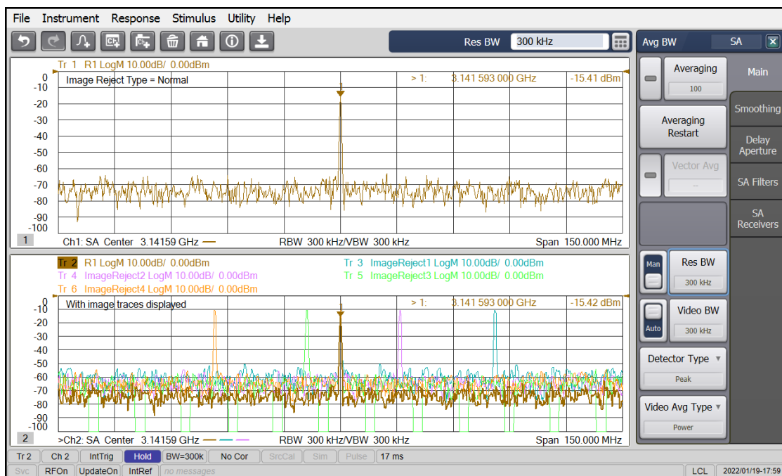
图 37. 常规镜像抑制（顶部）和显示镜像信号的特殊诊断模式（底部）。
