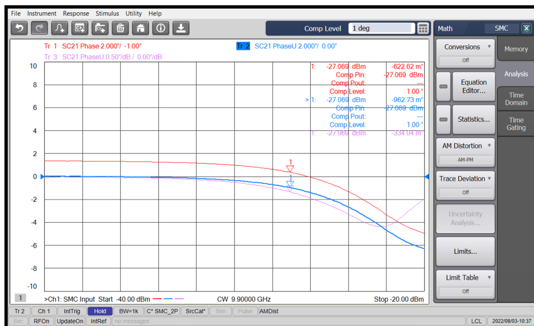
图 16. 使用功率扫描进行相位与驱动和 AM-PM 转换测量的结果。
