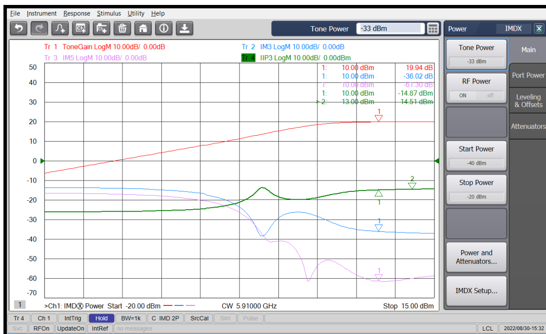
图 30. 扫描外部 LO 信号功率，同时测量变频器增益和 IMD 性能的示例。
