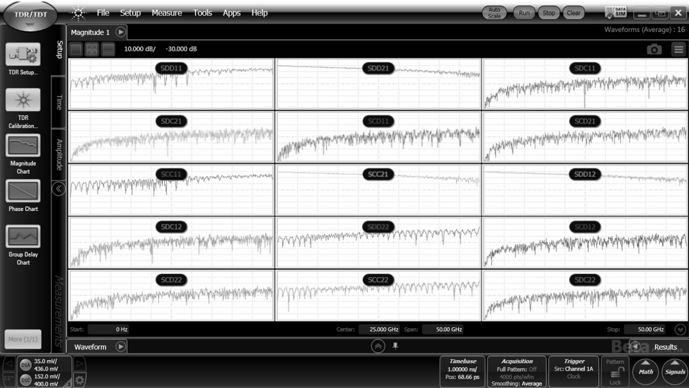
图 22: 86100 TDR 上的实时板上频域结果，其中显示了双端口差分 DUT 的全部 32 个 S 参数
