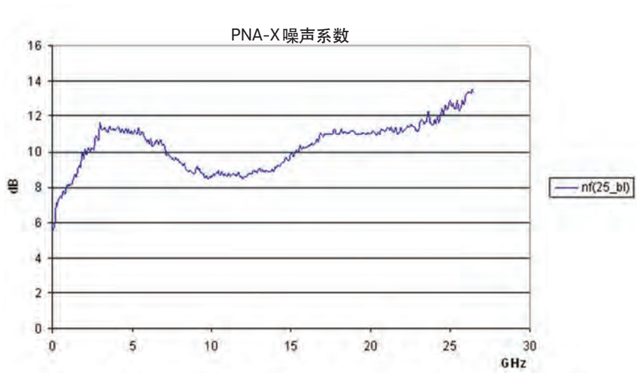
图 28. 端口 2 的典型噪声系数
