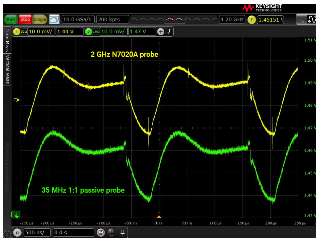
图 12. 分别使用 35 MHz 1:1 无源探头和 2 GHz N7020A 电源探头测量 1.5 V DDR3 存储器电源噪声的结果比较。带宽较低的探头没有发现影响高速数字系统的高频噪声和尖峰。
