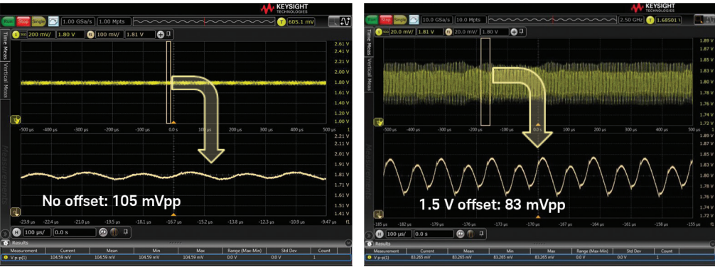
图 4. 使用和不使用探头偏置时测量 1.5 V 直流电源的噪声。
