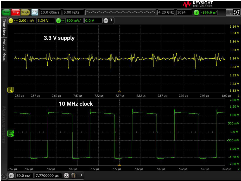
图 11. 基于 10 MHz 时钟进行触发并启用平均功能可消除所有随机噪声和与时钟不相干的信号。得到的结果是与 10 MHz 时钟相关的电源噪声。
